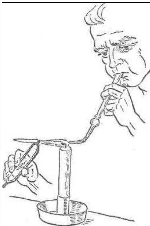
Fig. 6. El soplete, introducido en el laboratorio por el químico sueco Cronstedt (1722-1765), fue un instrumento clave de análisis durante más de un siglo, y se utiliza todavía. El aire soplado por el tubo aumenta y dirige el calor de la llama.
