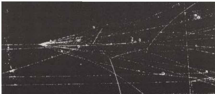
Creación de dieciséis partículas en una colisión entre un pión y un protón.
