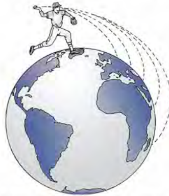
Figura 10.11 Una bola de béisbol lanzada horizontalmente con velocidad cada vez más grande tarde o temprano se convertiría en un satélite al “caer” alrededor de la Tierra.
