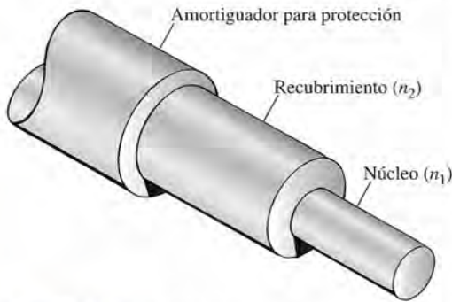
Figura 35.11 Estructura básica de una fibra óptica. El índice de refracción para el núcleo ( n_1 ) debe ser mayor que el índice de refracción para el recubrimiento ( n_2 ).
