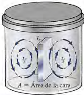
Figura 18.6 Cuando se coloca una placa caliente en un fluido frío, las corrientes de convección transfieren el calor lejos de la placa con una razón proporcional a la diferencia de temperaturas y al área de la misma placa.
