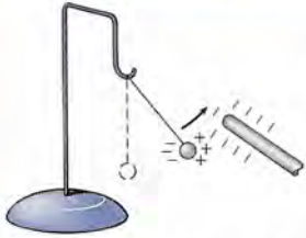
Figura 23.10 Atracción de un cuerpo neutro debido a la redistribución de la carga.
