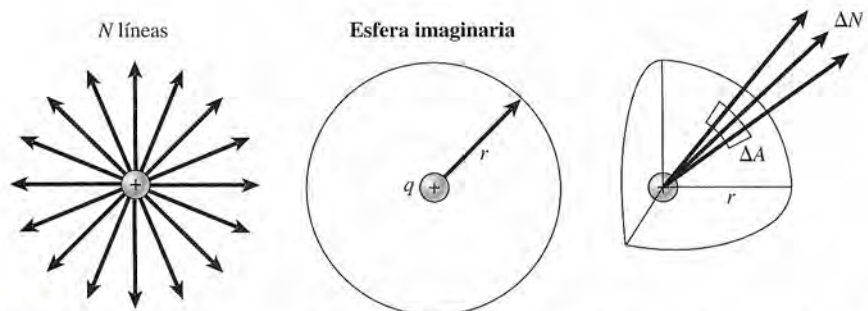
Figura 24.10 La intensidad del campo eléctrico a una distancia r de las cargas puntuales es directamente proporcional al número de líneas \Delta N que penetran por unidad \Delta A de una superficie esférica construida en esa distancia.
