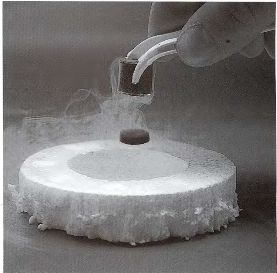
Figura 27.9 La levitación de una pequeña pieza de metal se logra cuando un material superconductor se enfría hasta la temperatura del nitrógeno líquido. (Cortesía de Science Kit & Boreal Laboratories.)
