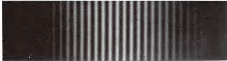
Figura 37.3 Fotografía de un patrón de difracción en el experimento de Young. (De F. A. Jenkins y H. E. White, Fundamentals of Optics , 4a. ed., McGraw-Hill Company, Nueva York, 1976. Reproducida con autorización.)
