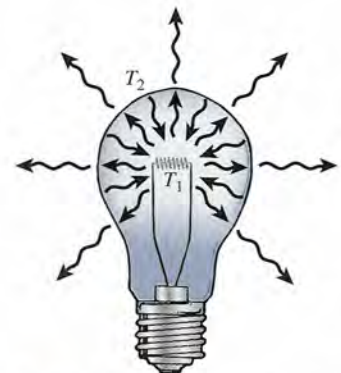
Figura 18.8 La energía neta emitida por un radiador en un entorno que tiene diferente temperatura.
