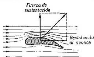
Fig. 105. Origen de la fuerza de sustentación del ala del avión.
