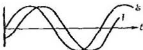
Fig. 304. Curvas de la variación con el tiempo de la f. e. m. \mathcal{E} y de la intensidad de la corriente I en el caso de una corriente alterna en un circuito con autoinducción.
