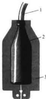
Fig. 90. Fabricación de una botella: 1-tubo; 2-vidrio; 3-molde.
