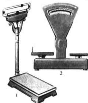
Fig. 158. Tipos de balanzas: 1—de médico; 2—comerciales de sobremesa; 3—de farmacia; 4—decimal.
