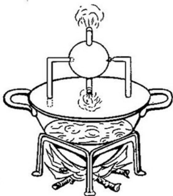
Fig. 8. La máquina (turbina) de vapor más antigua, llamada "eolípila", que se atribuye a Herón de Alejandría.
