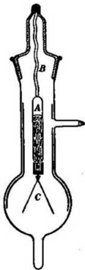
Fig. 100. Reloj de radio con "cuerda casi perpetua" para 1 600 años.
