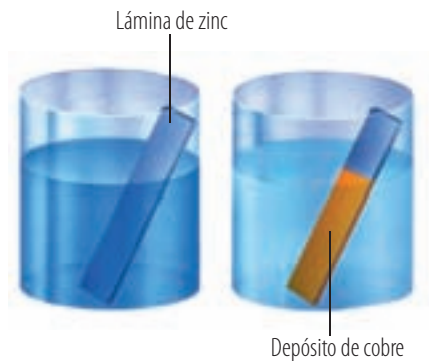
Figura 23. La reacción de una lámina de zinc en una disolución de sulfato de cobre es un ejemplo de reacción de óxido-reducción.
