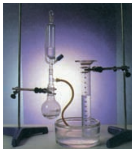
Figura 24. El hidrógeno es un elemento que se puede obtener en el laboratorio a partir de la reacción entre el ácido clorhídrico y el cinc.
