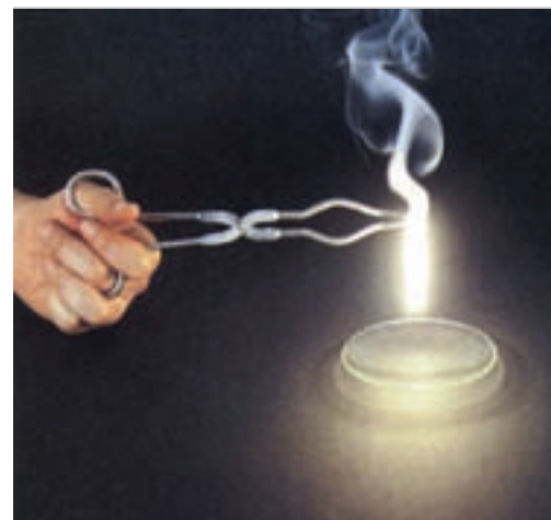
Figura 7. El magnesio arde en el aire dejando una ceniza que corresponde al óxido de magnesio.
