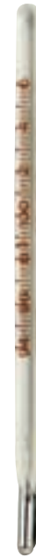
Figura 15. El termómetro es el instrumento empleado para medir la temperatura de los cuerpos.
