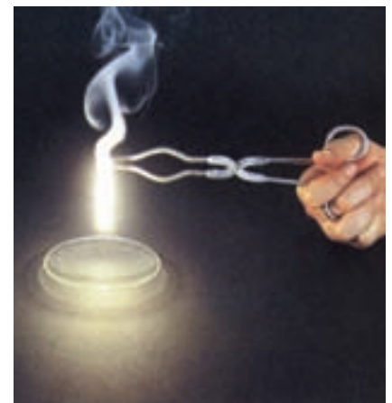
Figura 40. El magnesio arde con el aire y deja una ceniza blanca que corresponde al óxido de magnesio.
