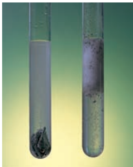
Figura 20. El zinc en virutas (izquierda) y en polvo (derecha) y el ácido clorhídrico (reactivos) reaccionan para formar cloruro de zinc (producto).
