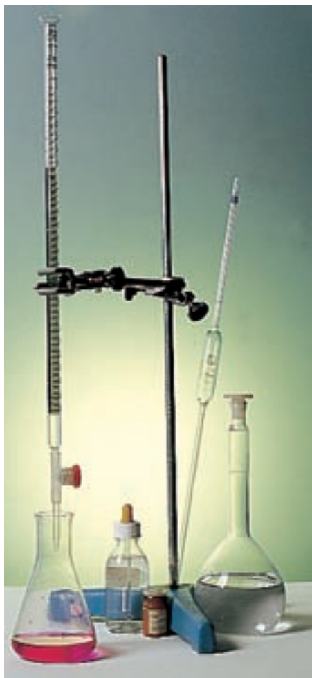
Figura 22. Montaje para realizar una titulación.
