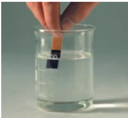
Figura 12. Los ácidos y las bases se pueden diferenciar porque modifican el pH de las soluciones acuosas. a) Se muestra un ácido, que colorea de rojo el papel de tornasol. b) Se muestra un hidróxido, coloreando de azul el papel de tornasol.
