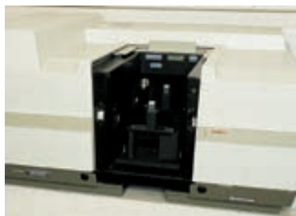
Figura 1. El espectrofotómetro permite medir paso a paso los cambios en las concentraciones de reactivos y productos.
