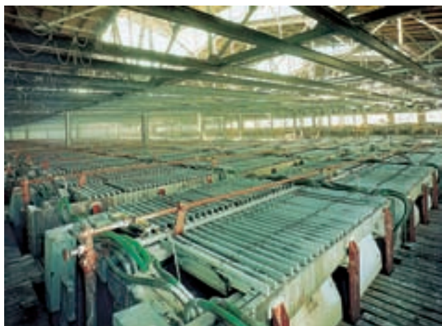
Figura 30. Celdas electrolíticas para la purificación de diversos metales.
