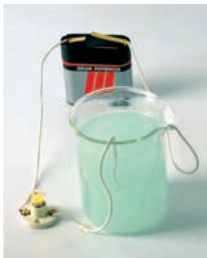
Figura 1. Este sencillo dispositivo se emplea para comprobar la conductividad de las soluciones de electrólitos.
