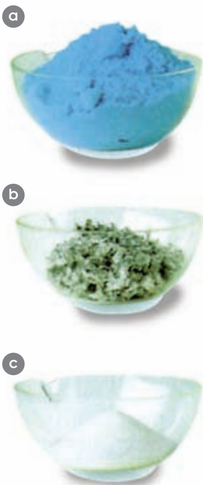
Figura 15. Volúmenes comparativos de un mol de: a) sulfato de cobre (249,5 g); b) zinc (65 g) y c) cloruro de sodio (58,5 g).
