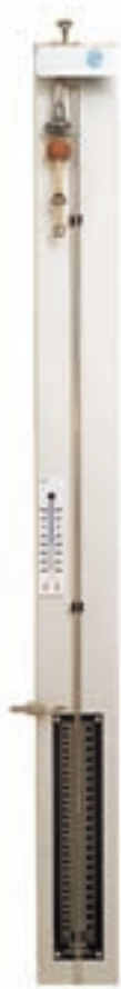
Figura 16. El barómetro de mercurio permite medir la presión atmosférica. Fue ideado por Evangelista Torricelli.
