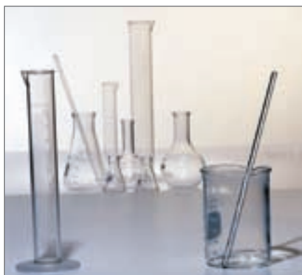
Figura 12. Para preparar soluciones se necesitan distintos instrumentos de laboratorio: vasos de precipitados, Erlenmeyer, probetas, matraces y tubos de ensayo.
