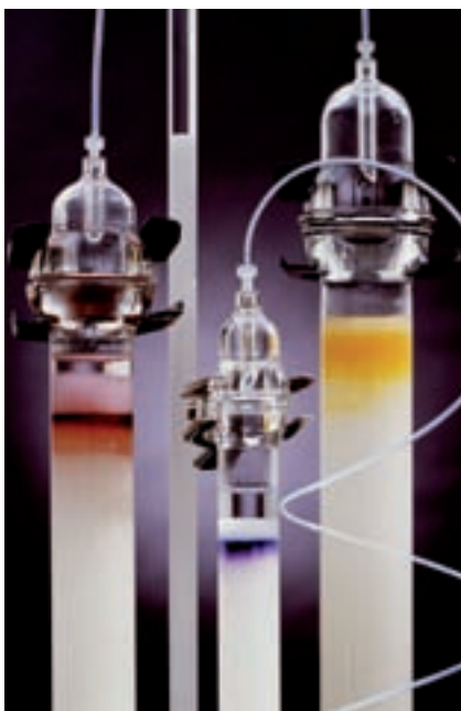
Figura 29. Equipo utilizado en la técnica de cromatografía en columna.
