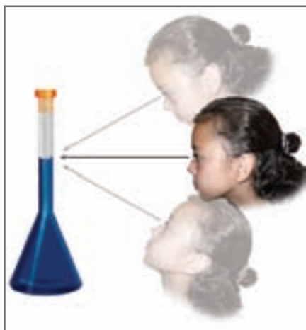
Figura 17. Para realizar una medida precisa de la cantidad de líquido que se encuentra dentro de un recipiente, se debe observar el menisco a la altura de los ojos. La parte baja del menisco indicará la medida.
