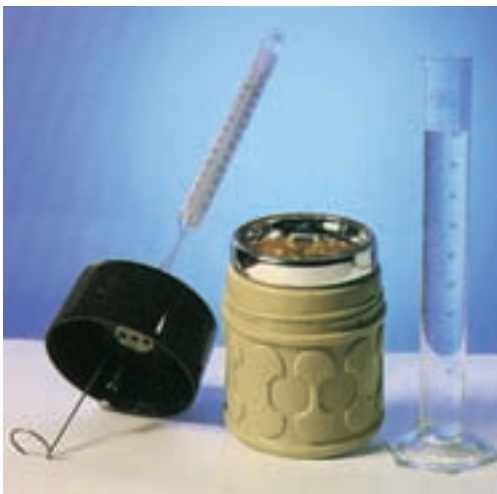
Figura 14. El calor se mide mediante un calorímetro y se expresa en unidades denominadas calorías.
