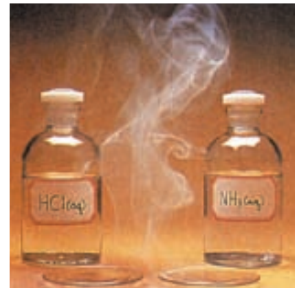
Figura 21. Reacción de \text{HCl}_{(\text{g})} y \text{NH}_{3(\text{g})} para formar \text{NH}_4\text{Cl}_{(\text{s})} .
