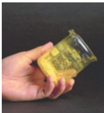
Figura 44. Cuando se produce una reacción en el laboratorio parte del producto puede quedar adherido a las paredes del recipiente lo que disminuye el rendimiento de la reacción.
