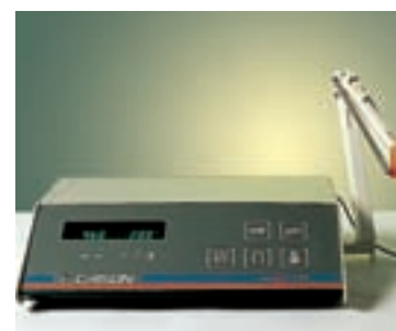
Figura 11. El pH se mide con un instrumento denominado pHmetro, que utiliza un electrodo muy sensible para medir el grado de acidez de una disolución.
